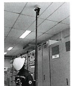
รูปที่ 9 การทดสอบ Smoke Detector ชั้น 1 ห้อง Terminal Substation อาคาร Switchyard
